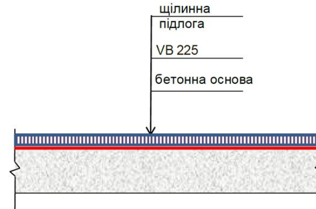
Рисунок I-15-2. Стандартна схема конструкції бетонних основ під пластикові щілинні підлоги, що експлуатуються у вологих агресивних середовищах
