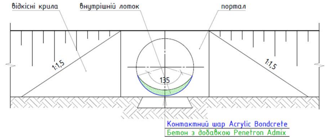
Рисунок IV-1-3. Конструктивна схема влаштування бетонного лотка всередині труби
