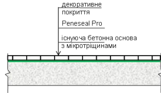
Рисунок П-12-2. Стандартна схема зміцнення існуючих бетонних основ, що піддаються тепловим навантаженням
