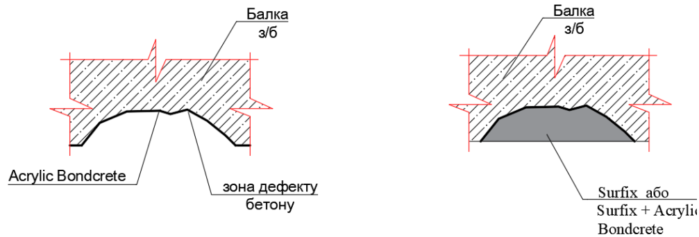
Рисунок 1 Типовий спосіб використання матеріалу Acrylic Bondcrete
