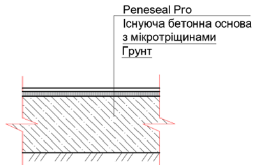
Рисунок 1 Приклад стандартної схеми конструкції із застосуванням PenesealPro.
