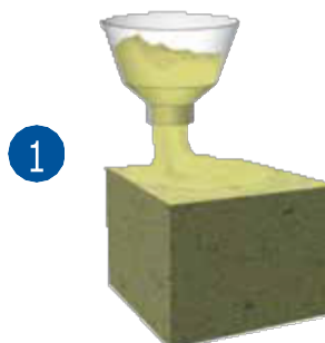
1 PENETRON ADMIX додається до бетону під час замішування.
